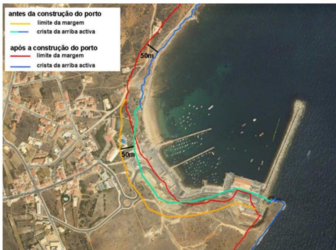
Figura 23. Conforme o artigo 13.º, da Lei n.º 54/2005 – PT, há a figura do RECUO das ÁGUAS, o que leva à alteração do traçado da linha demarcatória das margens marítimas. Nota. Observa – se na imagem que a linha amarela foi alterada após as obras que resultaram em terreno acrescido. Fonte: Imagem retirada da obra de (Teixeira S. B., 2009, p. 179), legendada no original “alteração dos limites da margem das águas do mar associadas à construção do porto de pesca de Sabres. Base cartográfica utilizada – mapa aerofotogramétrica do INAG de 2002, ortofotografia de 2005.”
